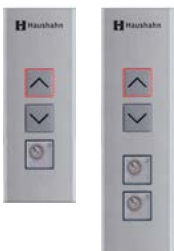
Etagentableau (LOP) mechanische Tasten mit Schlüsselschalter, Edelstahl gebürstet - teileingelassen in Wand (Mauerkasten) 90 x 225 mm, 90 x 295 mm - teileingelassen im Türrahmen 65 x 225 mm, 65 x 290 mm
